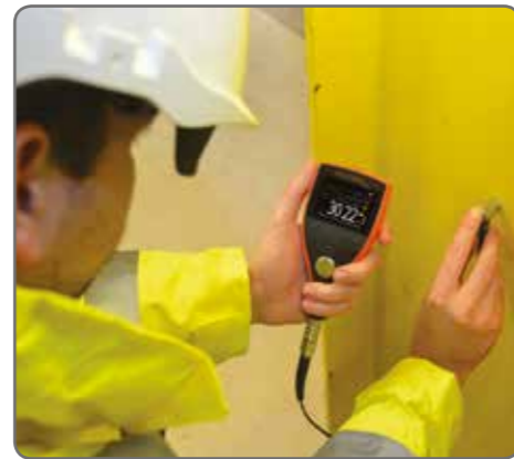
Los medidores disponen de todas las funciones y la funcionalidad necesarias para medir el espesor y la velocidad del sonido prácticamente en cualquier material y en gran variedad de aplicaciones.
