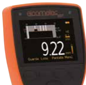
B-Scan bidireccional de corte de transversal, idóneo para análisis de profundidad relativa.
