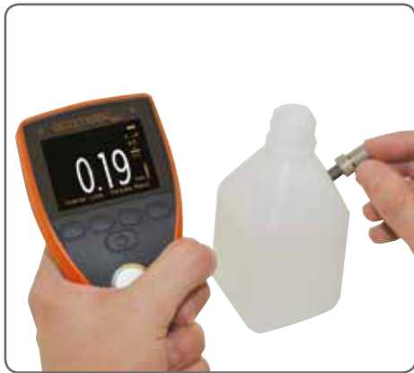
La gama PTG de medidores de espesor por ultrasonido tiene una precisión de \pm 1\% desde 0,15 mm (0,006") hasta 25,40 mm (1,000").
