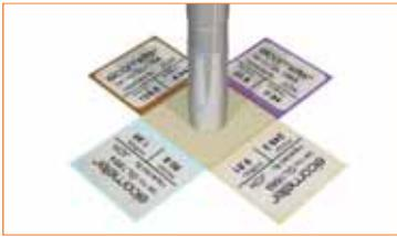
Cuando esté calibrando un medidor de espesor de revestimientos utilizando las galgas de calibración Elcometer, coloque la sonda sobre el centro de la galga, teniendo cuidado de no apoyar la sonda o el medidor con sonda integrada Bigfoot™ en la etiqueta.
